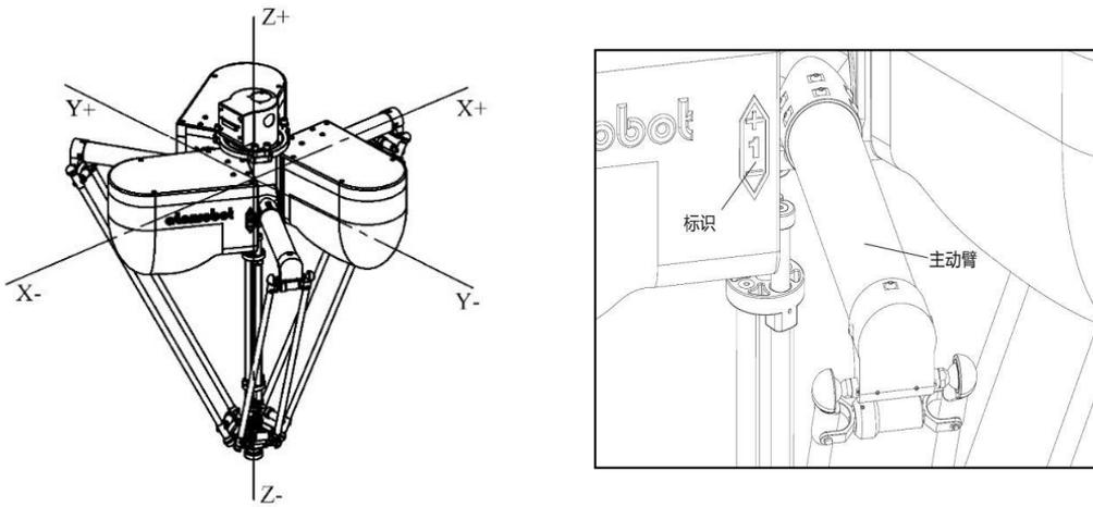
图 2-12 D3P-1100-P0 本体世界坐标定义
