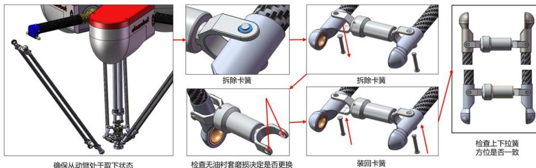
图 3-5 更换拉簧及无油衬套
