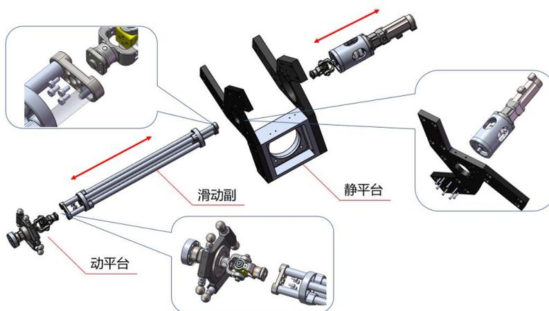
图 2-15 中间轴拆装示意
